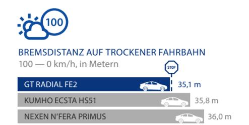
Die Tests wurden vom TÜV Süd auf Anfrage von Giti Tire im April-Mai 2021 auf dem Gelände von ATP Papenburg für Trocken- und Nass- tests mit einem VW Golf, auf Reifengröße 205/50R17 durchgeführt. GT Radial wurde mit folgenden Wettbewerben im gleichen Segment verglichen: Nexen N'fera Primus und Kumho Ecsta HS51. Anhang-Bericht Nr. 713209213-BM.
