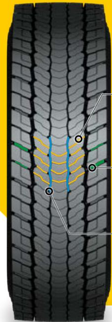
Große, miteinander verbundene Profilblöcke erzeugen in Verbindung mit den 3D Lamellen einen Synergieeffekt sorgen für erhöhte Steifigkeit, kontrollierte Profilblockbewegung und herausstechende Laufleistung.
