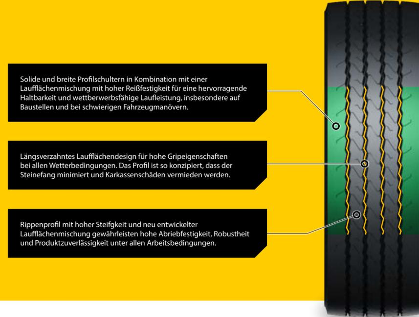
Solide und breite Profilschultern in Kombination mit einer Laufflächenmischung mit hoher Reißfestigkeit für eine hervorragende Haltbarkeit und wettbewerbsfähige Laufleistung, insbesondere auf Baustellen und bei schwierigen Fahrzeugmanövern.
