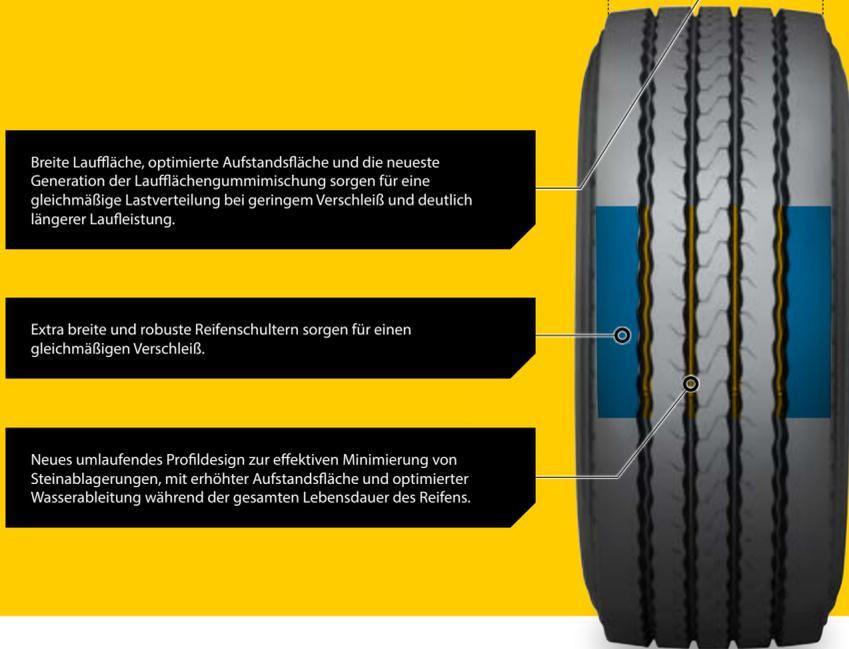
Breite Lauffläche, optimierte Aufstandsfläche und die neueste Generation der Laufflächengummimischung sorgen für eine gleichmäßige Lastverteilung bei geringem Verschleiß und deutlich längerer Laufleistung.
